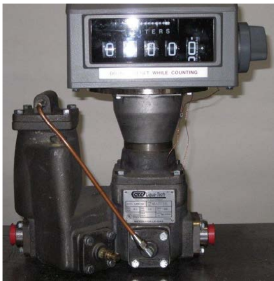
Фото 1.3 - Общий вид схемы пломбировки счетчика модификации LPM-102
