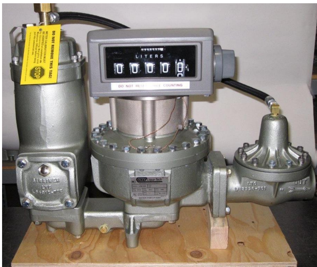
Фото 1.5 – Общий вид схемы пломбировки счетчика модификации LPM-200
