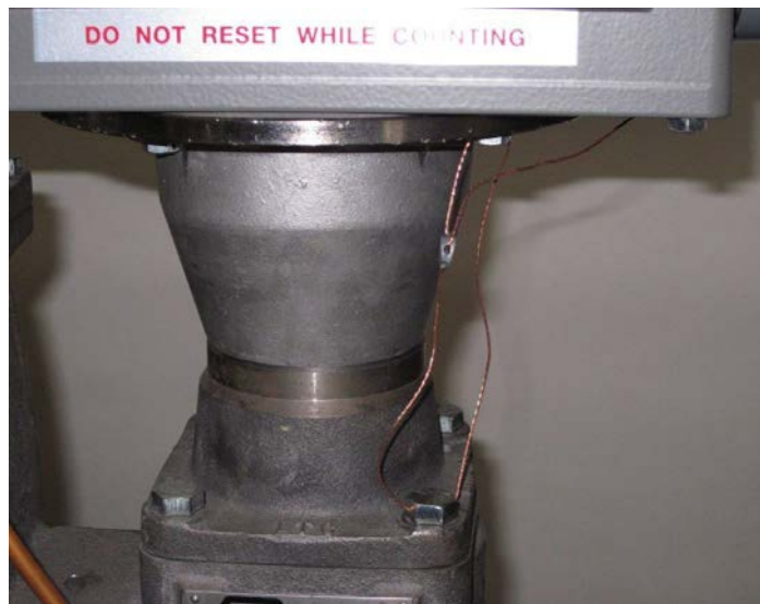
Фото 1.4 - Схема пломбировки измерительной камеры и регистратора счетчика модификации LPM-102
