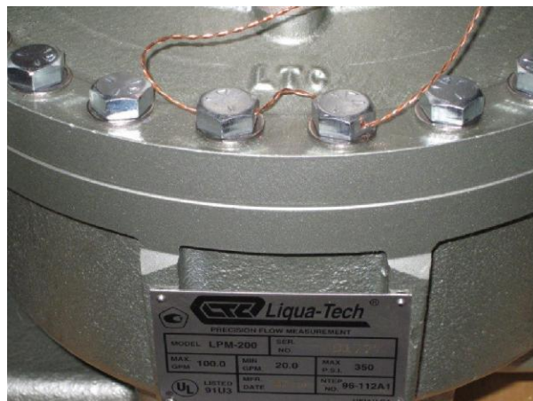
Фото 1.6 – Пломбировка измерительной камеры счетчика модификации LPM-200
