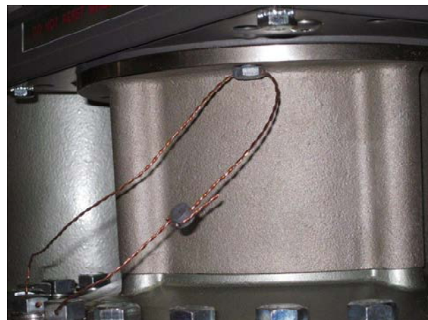
Фото 1.7 – Пломбировка регистратора счетчика модификации LPM-200
